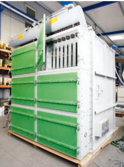
Aufsatz-Taschenfilter mit 67,50 m 2 Filterfläche für eine Hammermühlenspiration
